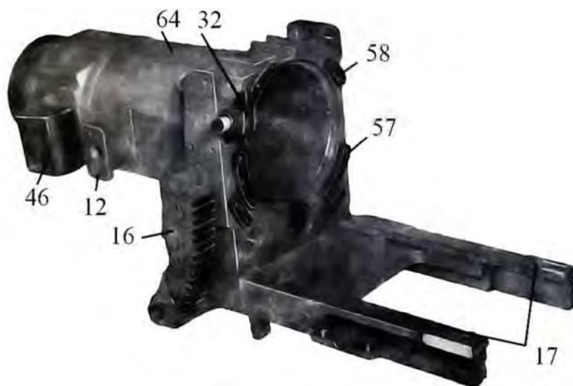
Рис. 4.29. Общий вид люльки: 12 – кронштейн; 16 – сектор; 17 – вкладыш; 32 – ускоритель; 46 – левая обойма цапфы; 57 и 58 – буфера; 64 – люлька
