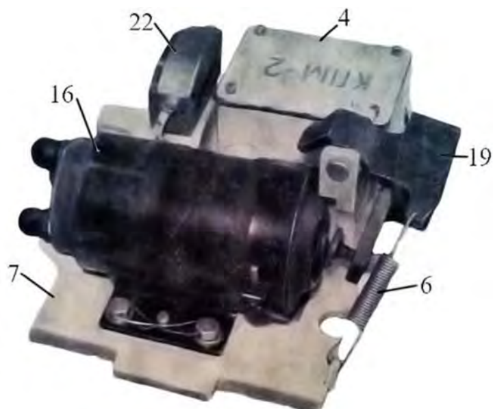
Рис. 4.19. Общий вид спускового механизма: 4 – соединительный блок; 6 – пружина нажима; 7 – основание; 16 – электромагнит ЭМ-1Г (У); 19 – полка в сборе; 22 – контактная пластина
