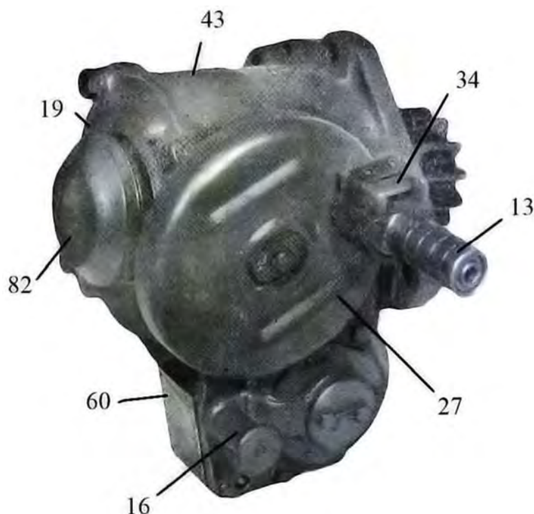
Рис. 4.33. Общий вид подъемного механизма: 13, 16 – рукоятки; 19 – крышка; 27 – маховик в сборе; 34 – спусковой рычаг; 43 – картер; 60 – блок переключателей; 82 – колпачок
