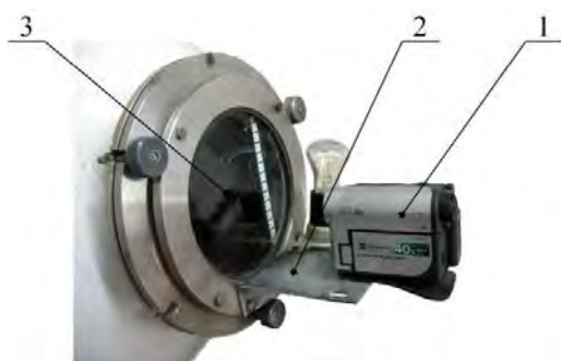
Рис. 2. Монтаж видеокамеры на загрузочном лючке
