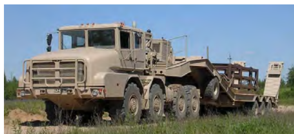
Рис. 1. Тягач со стеклопластиковой кабиной, оперением и капотом
