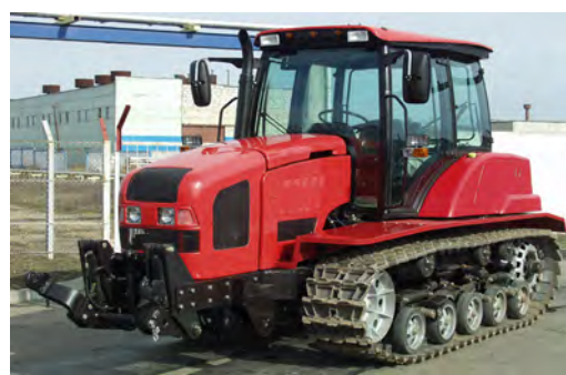
Рис. 2. Трактор со стеклопластиковой крышей, капотом и оперением
