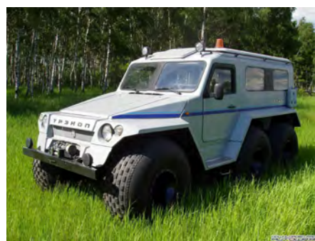
Рис. 3. Вездеход со стеклопластиковым кузовом, капотом и оперением
