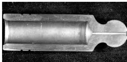
Рис. 3. Вид внутренних поверхностей поршня аксиально-поршневой гидромашины после очистки
