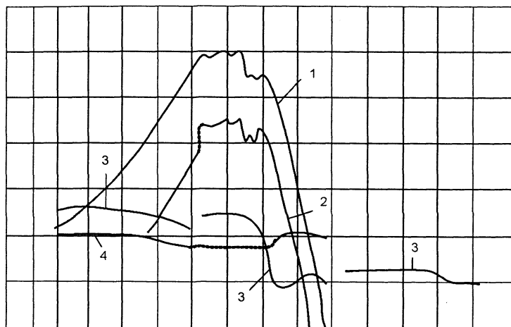
Рис. 3. Диаграмма горячего прессования SiC при постоянном давлении: 1 – температура по термопаре; 2 – температура по пирометру; 3 – уплотнение; 4 – нагрузка
