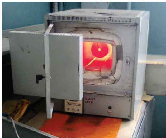
Рис. 1. Общий вид лабораторной ротационной установки для исследования процесса твердофазного восстановления окалины в динамическом подвижном слое
