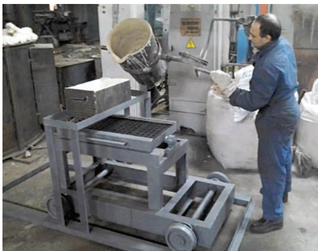
Рис. 4. Экспериментальная установка для литья мелких тел
