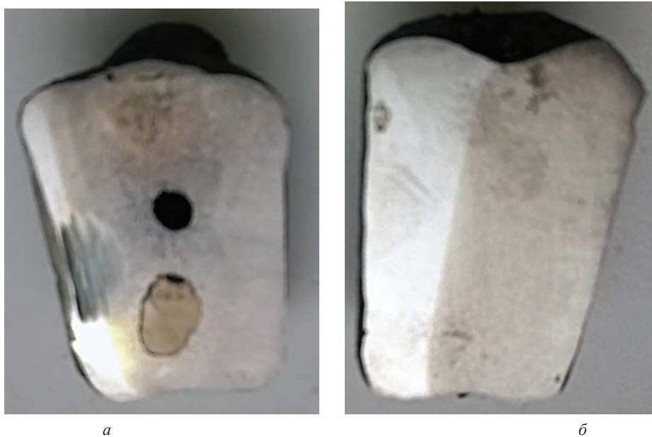
Рис. 5. Фотографии центрального сечения отливок полученных при заливке: а – в холодный кокиль; б – в подогретый кокиль
