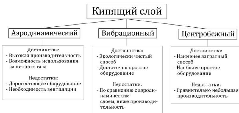
Рисунок 1 – Классификация видов псевдоожигения для термической и химико-термической обработки
