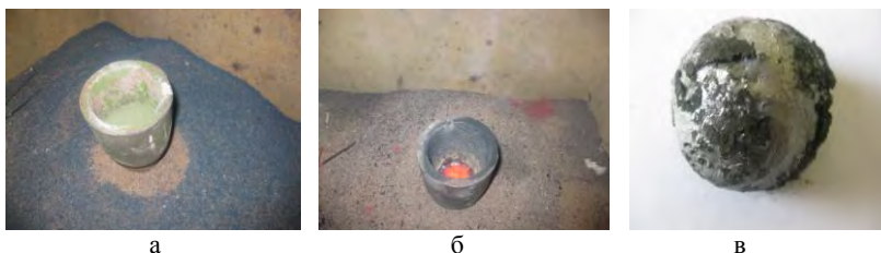
а – исходное состояние; б – после завершения плавки; в – полученный слиток
