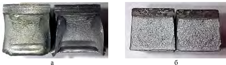
а – излом образца из стали 09Г2С; б – излом образца из стали 32Г2А Рисунок 2 – Изломы образцов исследуемых сталей
