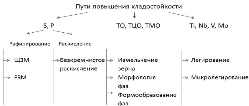
Рисунок 1 – Пути повышения хладостойкости конструкционных сталей
