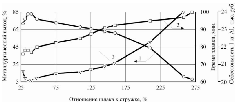
Рисунок 2 – Влияние отношения шлака к стружке с засором 25 % в составе металлозавалки на металлургический выход (1), длительность плавки (2) и себестоимость получаемого сплава (3)
