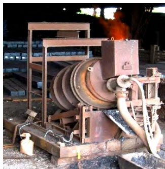
а – общий вид РНП емкостью 1,5 т; б – опытно-экспериментальная РНП емкостью 0,5 т 1 – корпус печи; 2 – привод вращения; 3 – крышка поворотная; 4 – зонт; 5 – дымоход; 6 – горелка; 7 – рама опорная; 8 – рама поворотная; 9 – привод наклона печи
