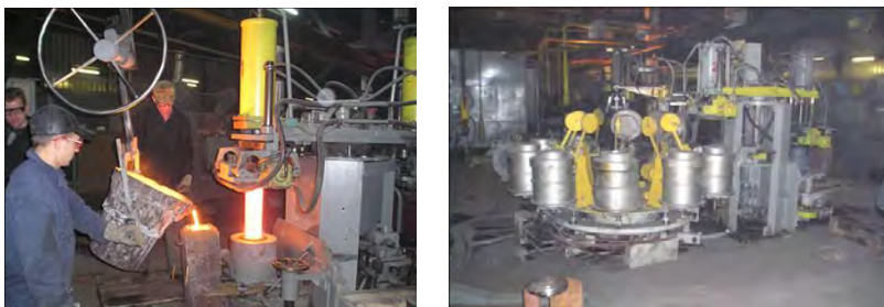
Рисунок 2 – Установка и оборудование для непрерывного литья намораживанием
