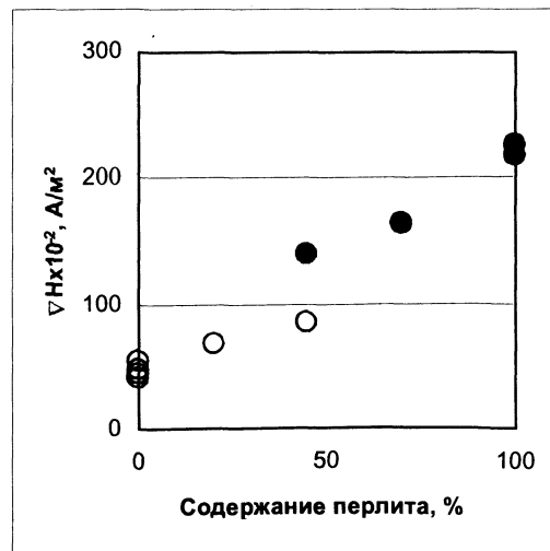
Рис. 3. Зависимость показаний прибора МАКСИ (а) и МС (б) от процентного содержания перлита в отливках со структурой высокопрочного (O) и серого (•) чугунов
