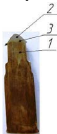
Рисунок 2 – Внешний вид деталей после СГВ бесступенчатой заготовки, без избыточной энергии \Delta E на пуансоне
