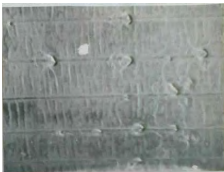
Рис. 1.16. Надрывы на наружной поверхности заготовки
