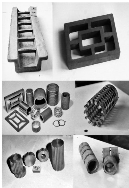
Рис. 1.20. Отливки, полученные на лабораторных установках с использованием разрушаемых стержней
