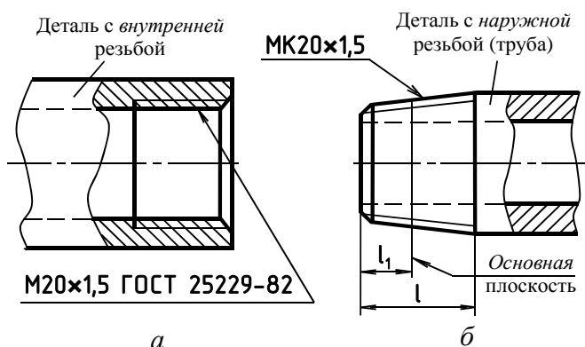
Рис. 2.6. Обозначение на чертеже внутренней цилиндрической резьбы с профилем по ГОСТ 9150–2002 (а), соединяемой с наружной метрической конической резьбой (б) по ГОСТ 25229–82
