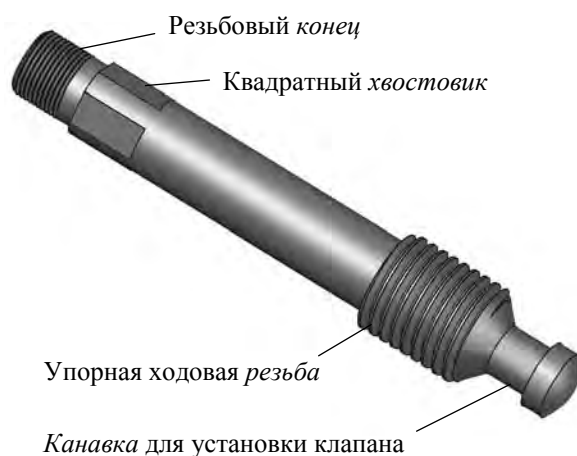
Рис. 1.30. Шпиндель водопроводного вентили
