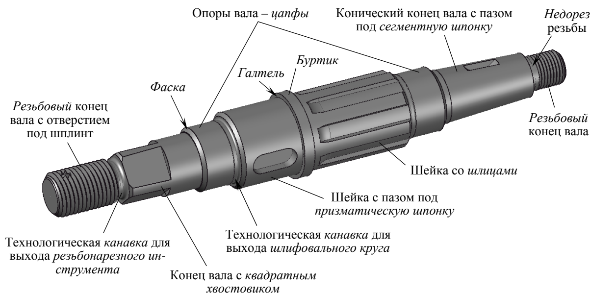
Рис. 1.2. Вал, комбинированный из ступеней разной формы с конструктивными элементами для фиксирования насаживаемых деталей и технологическими канавками
