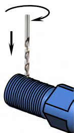
Сверление отверстия под шплинт
