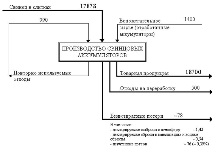
Рисунок 1 – Схема материальных потоков процесса производства свинцовых аккумуляторов
