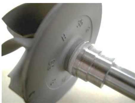
Рисунок 1 – Внешний вид ротора турбокомпрессора с колесом из сплава Inconel 713C и валом из стали 40X после ЭЛС
