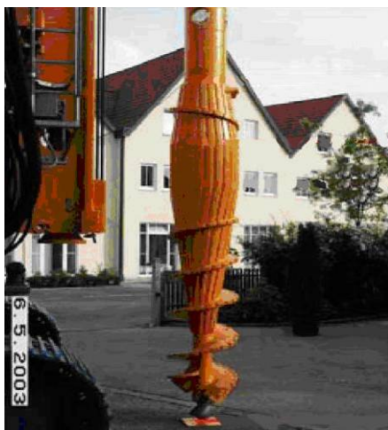
Рис. 9. Раскатчик скважин системы «Бауэр»
