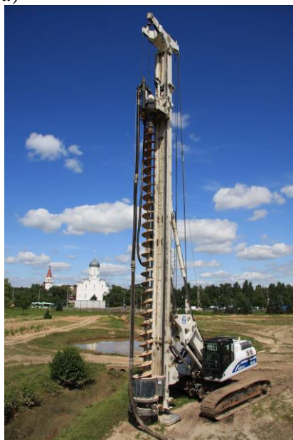
Рис. 7. Оборудование для устройства свай SFA: а - буровой станок со сплошным полым шнеком, б - буровой станок для походки скважин; в - подъем шнека с бетоном на лопастях и погружение вибратором арматурного каркаса в скважину
