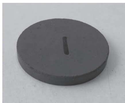
Рис. 6. Брикет с клеем ПВА в качестве связующего, проба № 1
