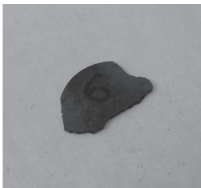
Рис. 3. Брикет с жидким стеклом в качестве связующего
