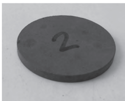
Рис. 7. Брикет с клеем ПВА в качестве связующего, проба № 2
