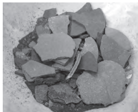
Рис. 4. Обломки брикетов с науглероживателем в качестве связующего
