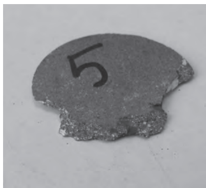
Рис. 2. Брикет с отсеvом извести в качестве связующего
