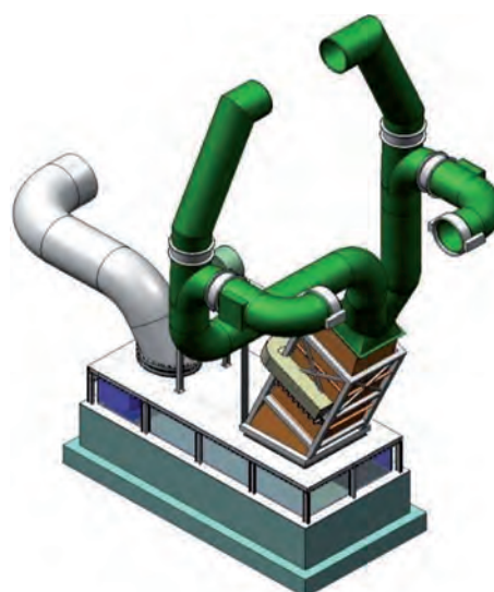
Рис. 9. Газоход отходящих газов с дожиганием и осадительной камерой
