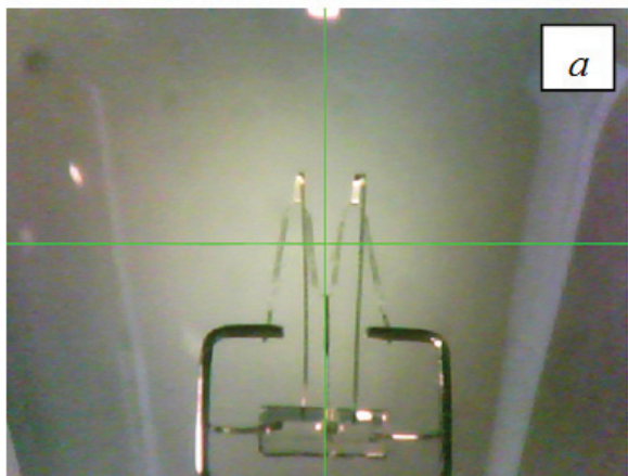
Рисунок 4 – Изображения тела накала светоизмерительной лампы силы света СИС-500, отъюстированной относительно оптической оси фотометрической установки: a – вид тела накала вдоль оптической оси фотометрической установки с камеры 10; b – вид тела накала под углом 90^\circ к оптической оси фотометрической установки с камеры 9
