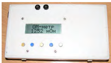
Рисунок 2 – Общий вид устройства для измерения сопротивления в зоне контакта отливки и стержня
