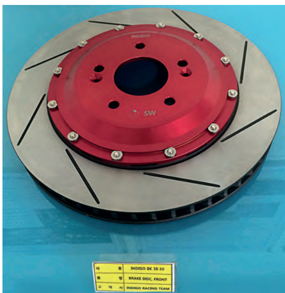
Рис. 9. Обработанные тормозные диски, изготовленные на литейном заводе Hyundai Сунгво
