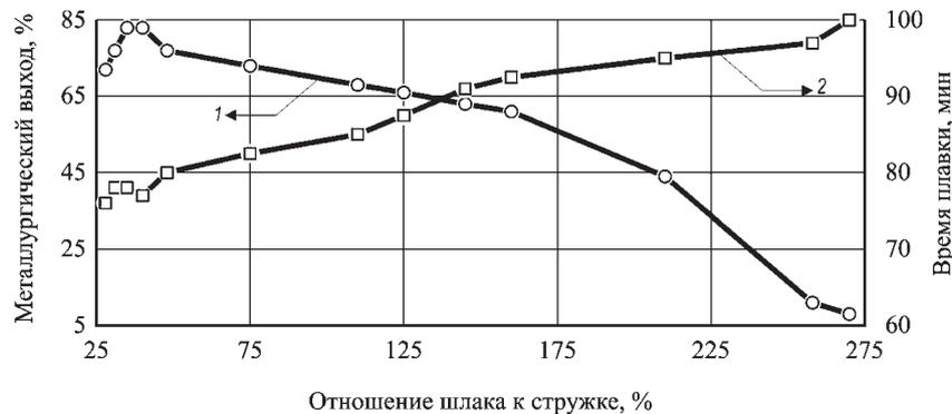
Рис. 2. Влияние отношения шлака к стружке с засором 25% в составе шихты на металлургический выход (1) и длительность плавки (2)
