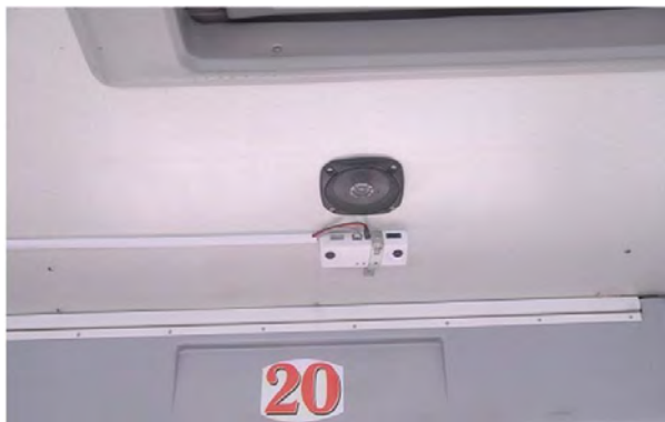
Рисунок 3 – Вид датчика системы установленный над входной дверью
