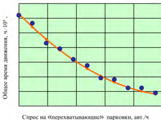
Рисунок 2 – Полиномиальная регрессионная модель изменения общего времени движения по транспортной сети в зависимости спроса на «перехватывающие» парковки
