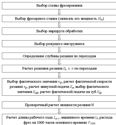
Рисунок 1 – Обобщенный алгоритм расчета режимов резания на фрезерных станках
