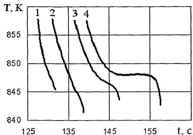
Рис. 7. Кривые охлаждения в одном сечении непрерывнолитой силуминовой отливки (время отсчитывается от первоначальной заливки в кристаллизатор): 1 – 1 мм от нижнего края отливки; 2 – 5; 3 – 10; 4 – 20 мм (центр)
