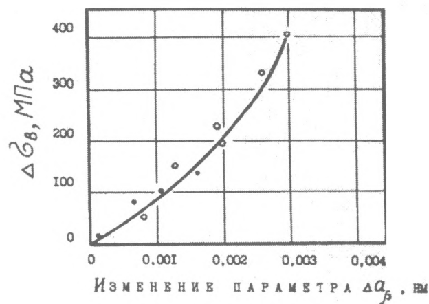
Рис. 5. Зависимость прироста временного сопротивления разрыву ( \sigma_v ) образцов крупногабаритных заготовок плиты толщиной 100 мм из сплава ВТ23, охлажденных после нагрева в течение 2 ч при температуре 700–850 °С в воде (—○—) и на воздухе (—●—), от изменения периода решетки \beta -фазы в процессе последующего старения при температуре 450 °С в течение 10 ч
