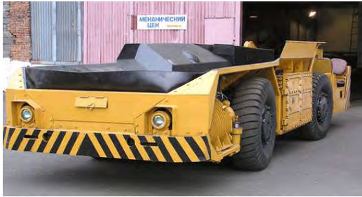
Рисунок 1 – Самоходный шахтный вагон 5BC-15М с донным конвейером
