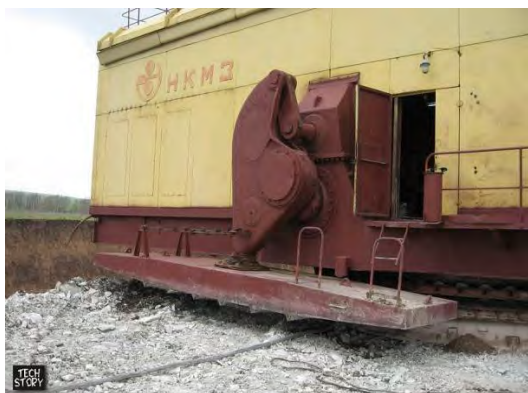
Рисунок 2 - Общий вид кривошипного механизма шагания
