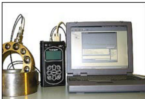
Рисунок 1 - переносной вибродиагностический комплекс СПЕКТР-07
