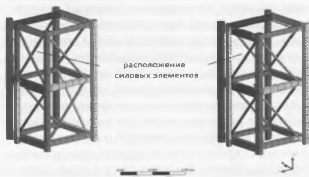
Рисунок 3 — Конечно-элементные модели секции мачты подъемника с различным расположением силовых элементов
