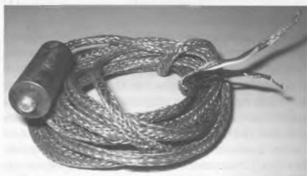
Рисунок 5 — Индукционные датчики измерения сил в опорах барабанных и дисковых тормозных механизмах: а — бесконтактный индукционный датчик дифференцирования электрического сигнала, пропорционального скорости
