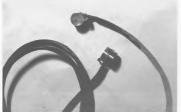
Рисунок 13 — Датчик регистрации изменения магнитной проницаемости металла при воздействии на него нагрузок
