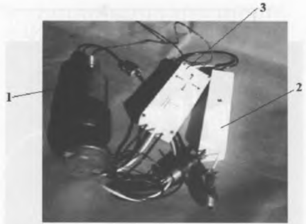
Рисунок 18 — Шкворень седельно-сцепного устройства автопоезда в составе тягача МАЗ-64229 и полуприцепа МТМ 9330, включающий устройство измерения сил между тягачом и полуприцепом: 1 — шкворень седельно-сцепного устройства; 2 — электронный блок обработки информации; 3 — светодиодный индикатор
