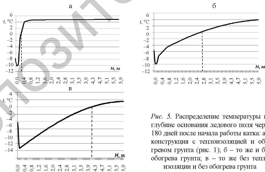
Рис. 5. Распределение температуры по глубине основания ледового поля через 180 дней после начала работы катка: а – конструкция с теплоизоляцией и обогревом грунта (рис. 1); б – то же и без обогрева грунта; в – то же без теплоизоляции и без обогрева грунта
