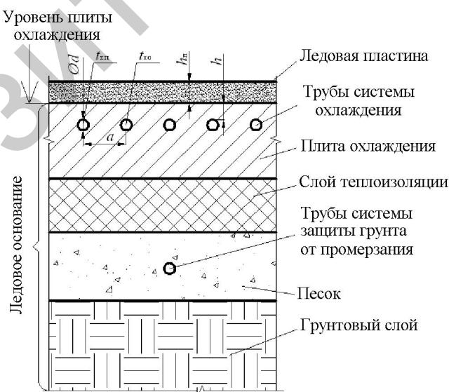
Рис. 1. Конструкция основания ледового поля на грунте:
