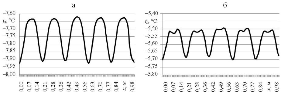
Рис. 3. Распределение температуры на поверхности льда: а – бетонная плита охлаждения; б – плита охлаждения из песчаной засыпки:  $t_{\text{хп}} = -11^{\circ}\text{C}$ ;  $t_{\text{xo}} = -10^{\circ}\text{C}$ ;  $t_{\text{оп}} = 10^{\circ}\text{C}$ ;  $t_{\text{oo}} = 5^{\circ}\text{C}$
