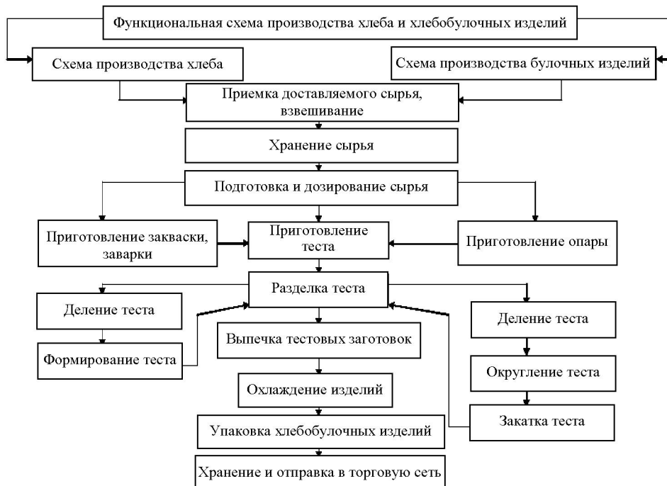
Рис. 1. Функциональная схема производства хлебобулочных изделий
