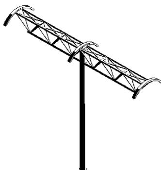
Рисунок 1. Геометрическая модель каркаса навеса остановки.
