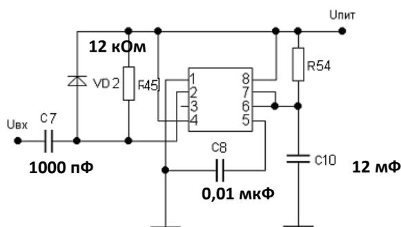
Рисунок 1.Схема одновибратора.
