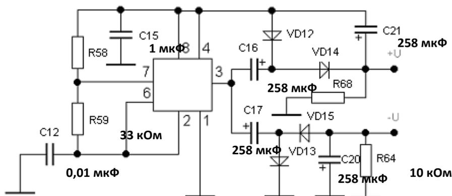
Рисунок 4. Диодно-ёмкостный преобразователь.
