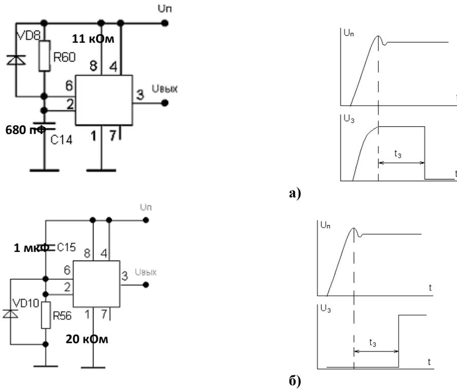
Рисунок 2. Одновибраторы, запускаемые по включению U<sub>п</sub>.
