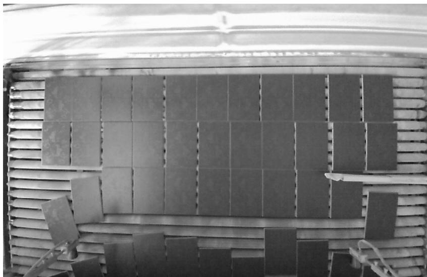
Рисунок 2. Рабочий кадр с камеры, зафиксированный в момент подхода плитки к стопорному ножу.
