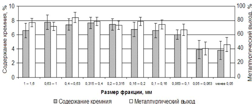
Влияние размера фракции кварцевого песка на содержание кремния в сплаве и металлургический выход сплава
