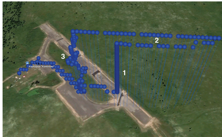
Рисунок 11 – Профиль полёта при тестовом запуске краткосрочной группировки атмосферных зондов: 1 – подъём БПЛА; 2 – рабочая траектория БПЛА; 3 – отстыковка и спуск пикоспутников
