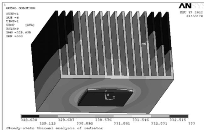
Рисунок 1 Распределение температур в материале радиатора
