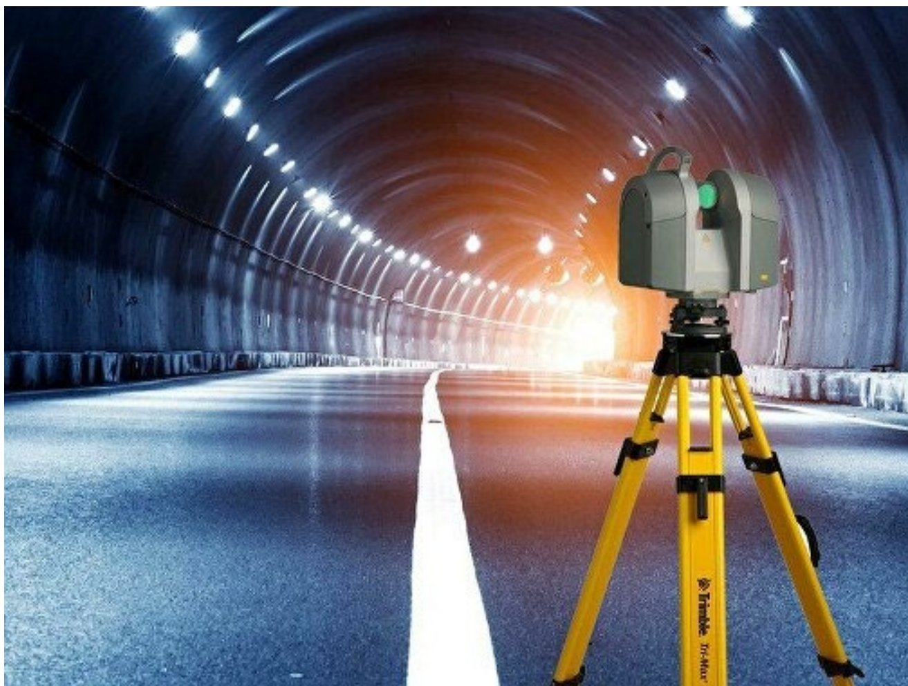
Рисунок 1 – Наземное лазерное сканирование транспортного тоннеля
