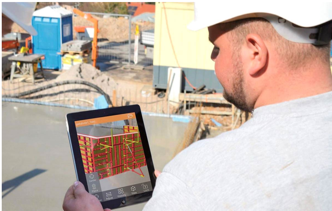
Рисунок 2 – Дополненная реальность в строительстве (монтаж опалубки)
