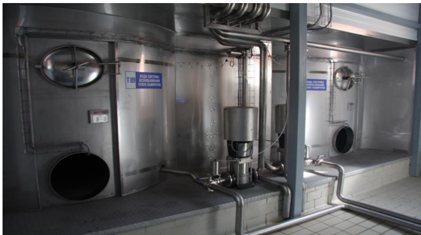
Рисунок 2 – Система подогрева тепла сыворотки для подогрева молока
