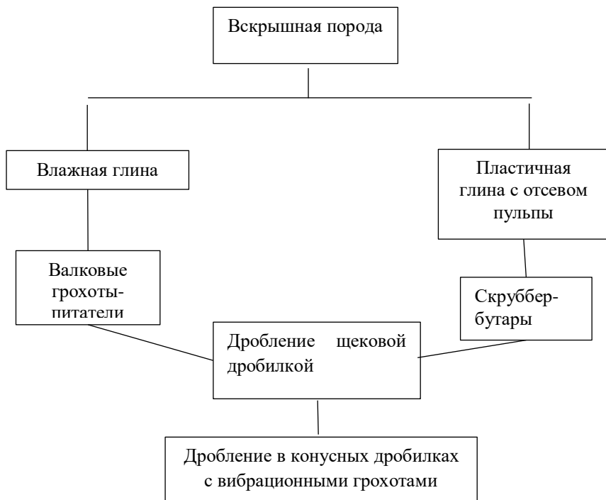
Рисунок 1 – Схема получения техногенного щебня из вскрышной породы
