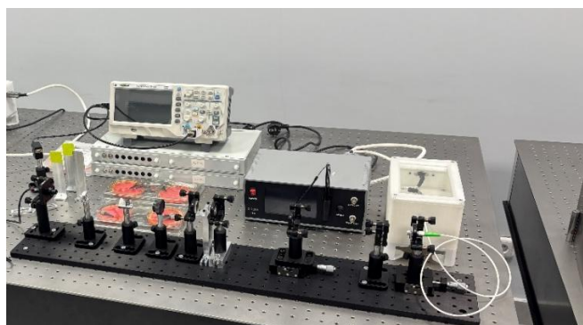
Рис. 1. Внешний вид дальномерного лазерного комплекса
