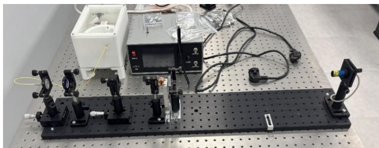
Рис. 1. Внешний вид научно-учебного лабораторного лазерного комплекса на основе кристалла Nd:YAG
