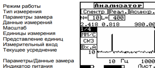
Рис. 2. Визуализация результатов измерения выходных характеристик датчика вибраций на приборе АГАТ-М
