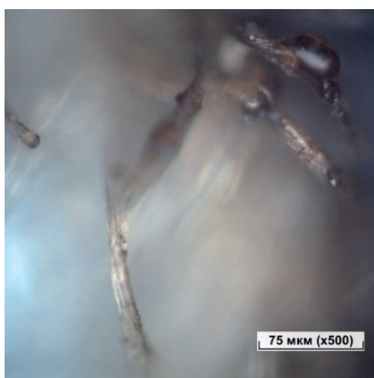
Рис. 4. Волокна ткани «Аркадия» в зоне разрушения: вложенная энергия 25 Дж, время воздействия 25 с
