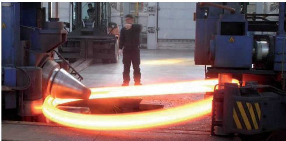
Рис. 3. Нарушение контакта инструмента с кольцевой заготовкой, приводящее к нарушению ее формы
